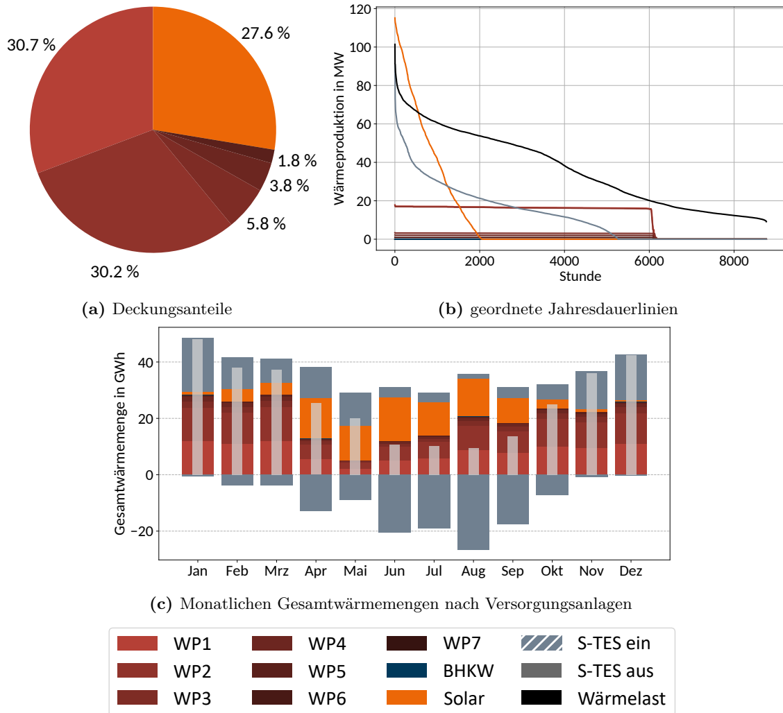
Abbildung 6.20: Deckungsanteile, Jahresdauerlinien und monatliche Gesamtwärmemenge nach Versorgungsanlage der parallelen Kompression mit offenem Economizer mit R1234ze(Z) für das 4GDH Netz in 2019
